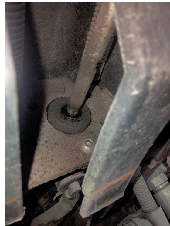
FUGA DE LIQUIDO DE FRENO EN BOMBA
