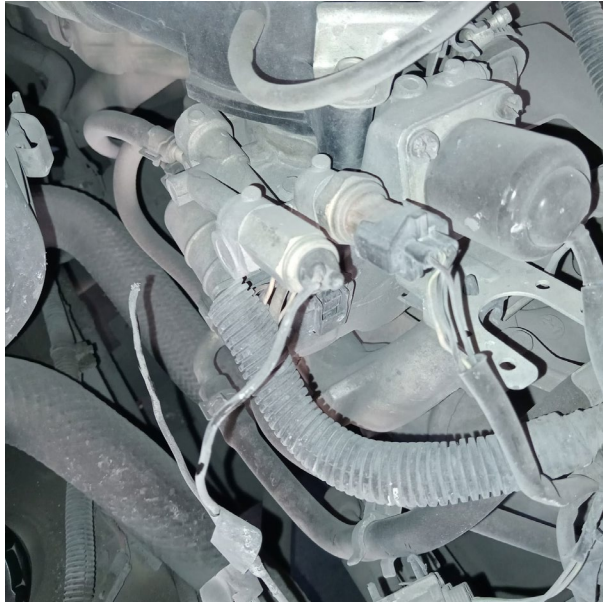
CABLE REVENTADO DE BOBINA CELENOIDE
