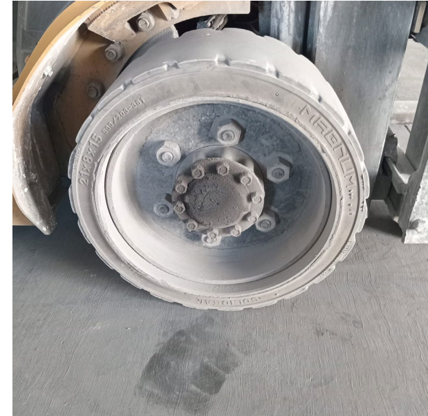
FUGA EN ACEITE DIFERENCIAL POR FLECHA LATERAL DERECHA
