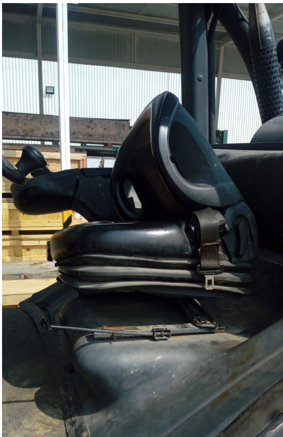
RIEL DEL ASIENTO DESCOMPUESTO
