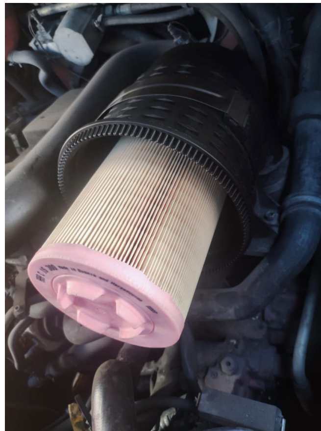
INSTALACIÓN DE FILTROS NUEVOS
