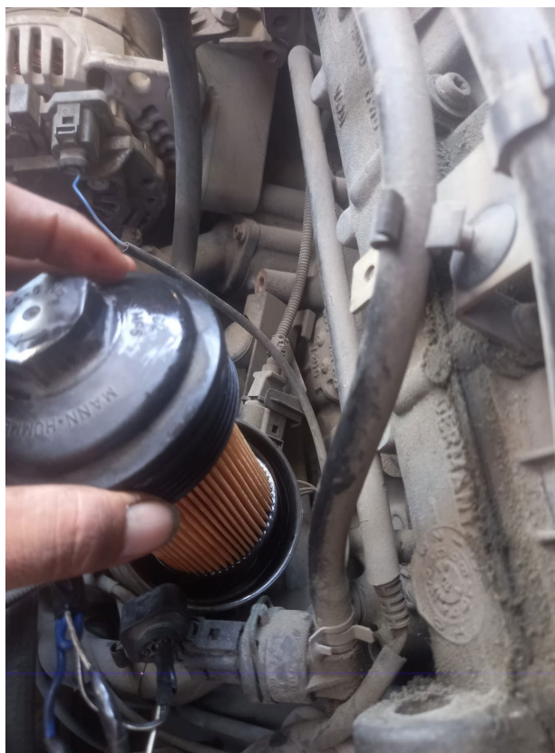
INSTALACIÓN NUEVO FILTRO DE ACEITE DE MOTOR
