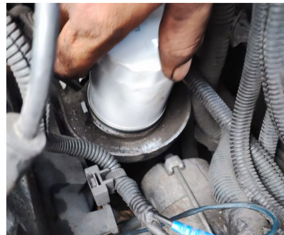
INSTALACIÓN DEL FILTRO NUEVO
