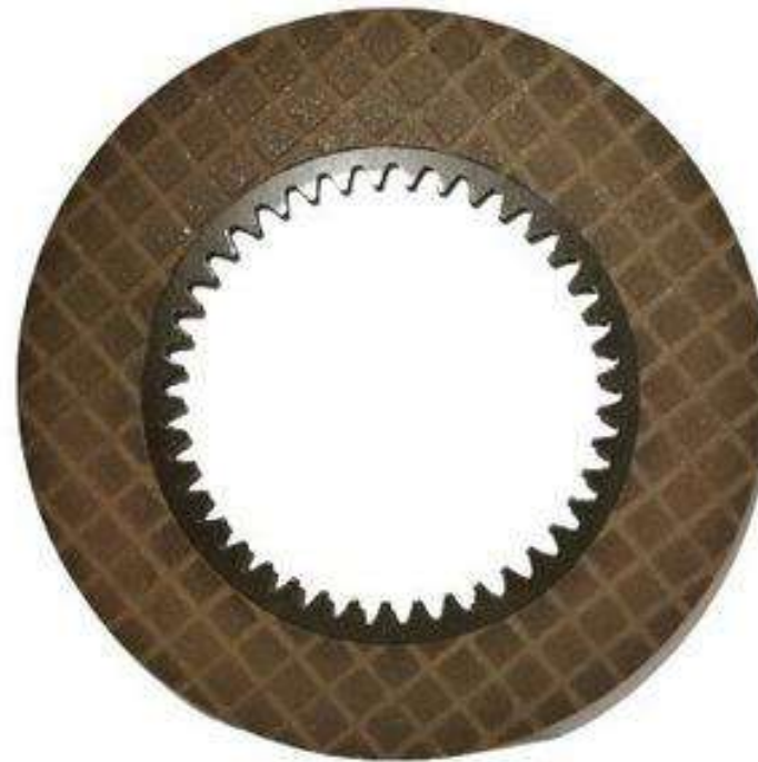
Un disco de paste en buenas condiciones debe contar con esta textura y el grosor adecuado.
