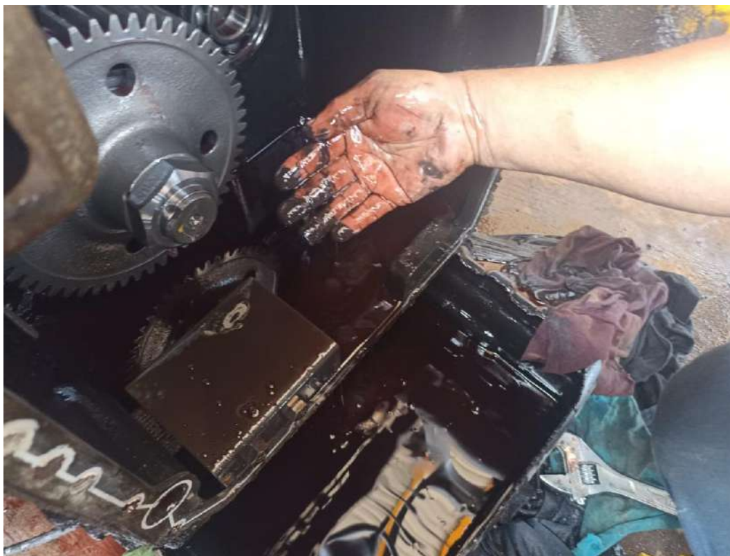
Residuos de pasta en hosing de transmisión
