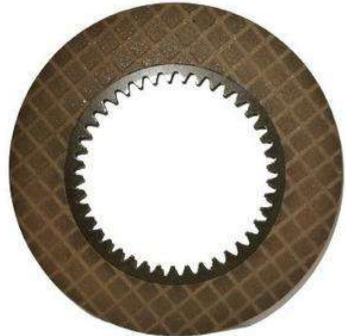
Un disco de paste en buenas condiciones debe contar con esta textura y el grosor adecuado.
