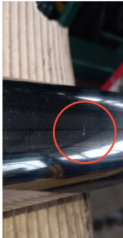
Golpe en elemento principal de cilindro de levante lateral
