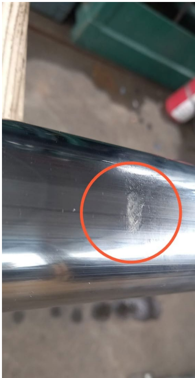
Daño de elemento principal de cilindro de levante lateral
