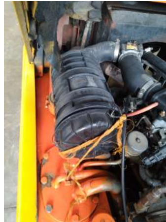
Base de filtro de aire rota
