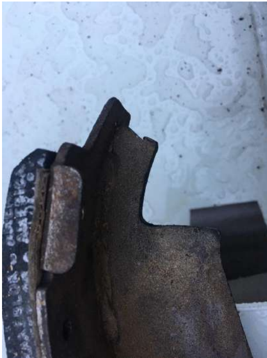
zapata del montacargas 05 (buena)
