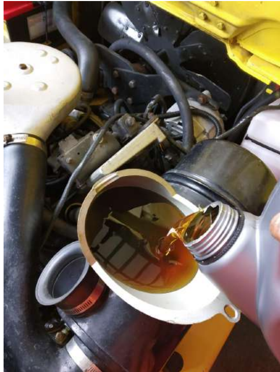
1.- Cambio de filtro y aceite de motor
